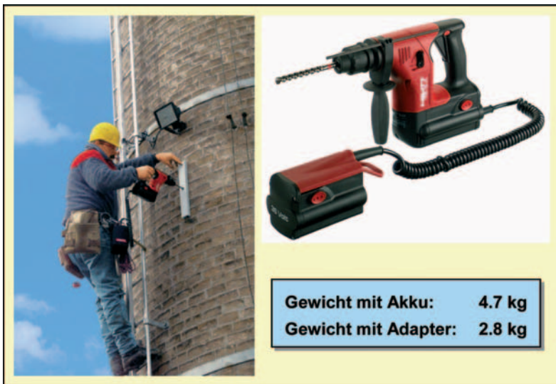
Abb. 5: Ergonomie- und gewichtsoptimierter, leistungsstarker Akku-Bohrhammer; Gewichtsreduktion durch Akku-Adapter zur Verlagerung des Akku-Gewichts an den Gürtel des Anwenders
